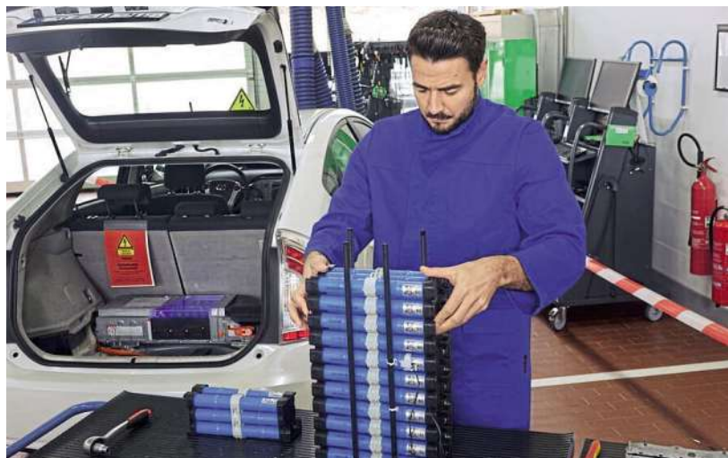
Bild 7: Mittlerweile sind die ersten Hybridfahrzeuge deutlich über zehn Jahre alt. Schwächelt die Hochvolt-Batterie, gibt es für ausgewählte Modelle einen Komplett-Reparatursatz.
