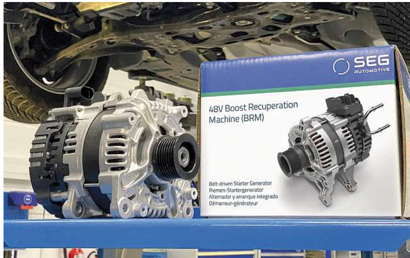
Bild 6: Wiederaufbereitete Generatoren und Starter gehören zu den klassischen Alternativen zum Neuteil. Mittlerweile gibt es auch Startergeneratoren für Mildhybrid-Antriebe als Reman-Produkte.
