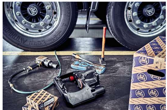
Bild 4: Speziell bei Nutzfahrzeugen spielt die Reparatur mit Reman-Produkten angesichts der TCO (Total Cost of Ownership) eine wichtige Rolle. Typisch ist der Verbau von wiederaufbereiteten Bremssätteln.
