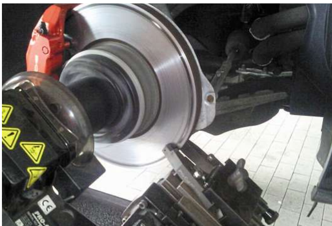
Bild 3: Ein aktuelles Beispiel für zeitwertgerechtes Reparieren an noch relativ jungen Fahrzeugen ist das Abdrehen von korrodierten Brems-scheiben von E-Autos.
