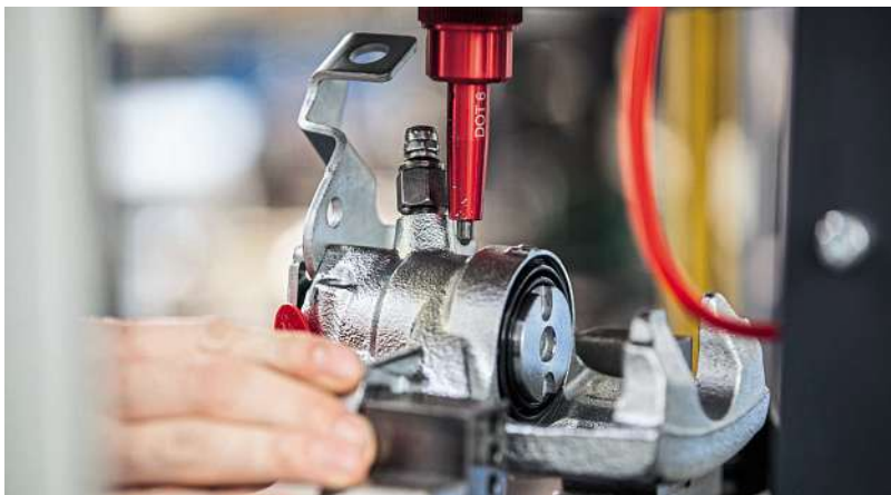
Bild 10: Zulieferer wie ZF verfügen über eigene Remanufacturing-Abteilungen. Dort arbeiten sie die Reman-Produkte nach industriellen Standards auf und versetzen sie in einen nahezu neuwertigen Zustand.
