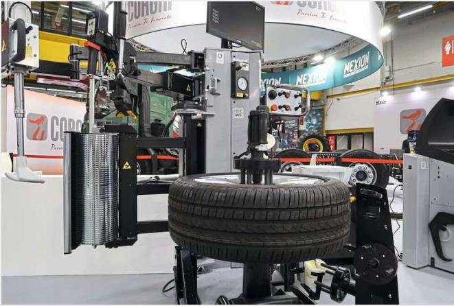
Montiermaschine Corghi Artiglio Uniformity, auf der linken Seite die Tastrolle. (Bild: Diehl – VCG)
